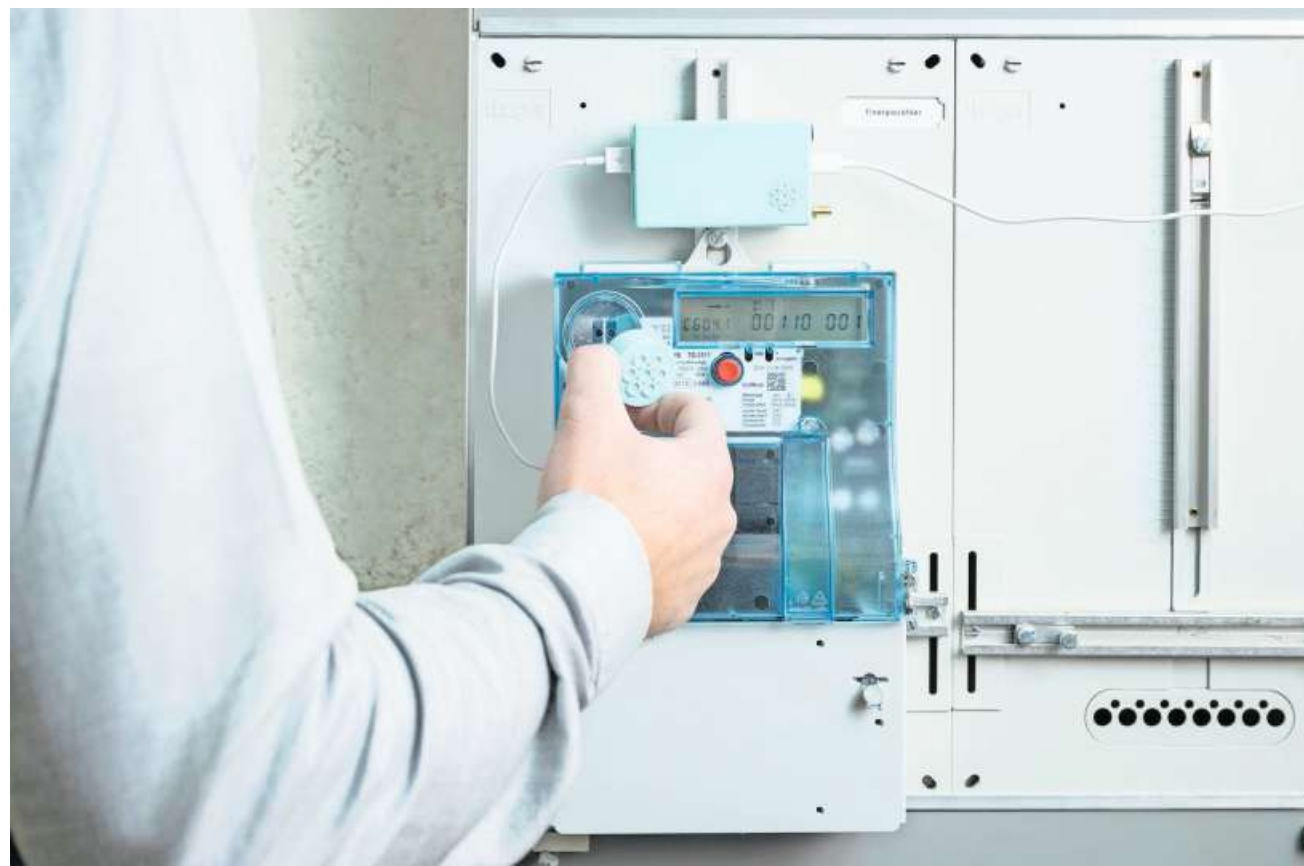
Das Herzstück der Lösung von Aliunid: Ein Gerät mit Sensoren liest am Stromzähler den Verbrauch ab.
